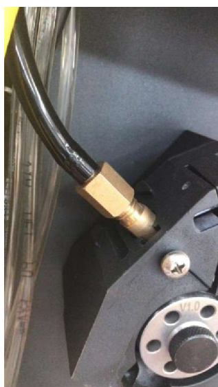
[Рисунок 2.1.2 Подключение пистолета подачи]
